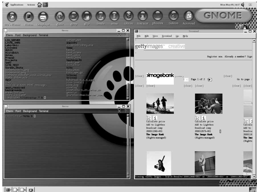
Figure 4-2 Deux terminaux Eterm avec transparence active et w3m, navigateur web en mode texte qui affiche des images dans un GNOME-terminal.
