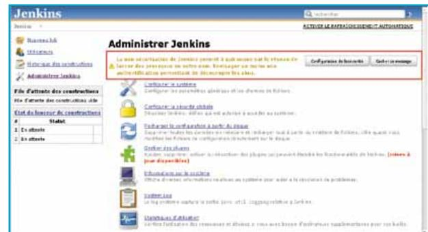
Fig. 2 : Première étape de la configuration : la sécurisation de l'installation
