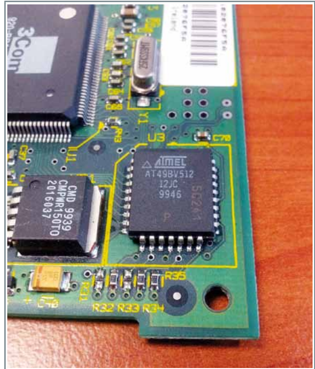
L'EEPROM flash parallèle équipant notre 3C905 est une Atmel AT49BV512 de 64Ko parfaitement prise en charge par flashrom. La programmation du composant est un jeu d'enfant, même si l'espace disponible ne permet pas d'embarquer absolument toutes les fonctionnalités de gPXE/iPXE.
