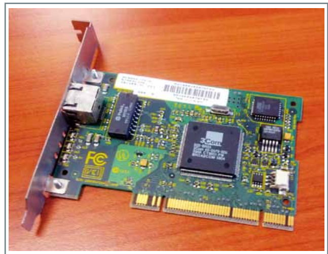
La carte Ethernet 3com 3c905C-TX/TX-M est une interface de choix pour créer un poste diskless disposant d'un emplacement PCI. Il existe bien entendu plusieurs modèles de 3c905, mais la plupart se voient équipés directement d'une EEPROM de boot soudée.
