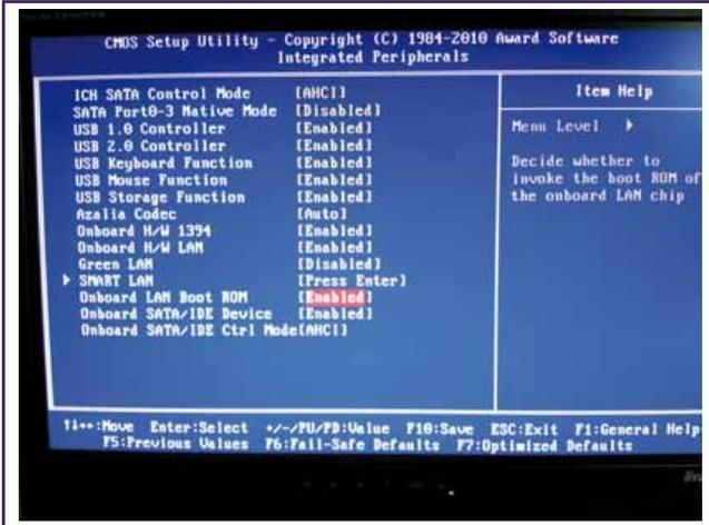
Fig. 2 : Exemple d'activation dans un BIOS de la capacité de démarrage de carte réseau : cela lui permet d'être sélectionnée comme périphérique amorceable
