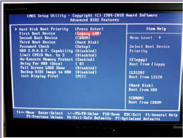
Fig. 3 : Exemple de paramétrage permanent d'ordre de démarrage au niveau du BIOS
