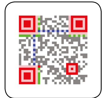
Fig. 2 : Les quatre différentes zones d'un code QR.
