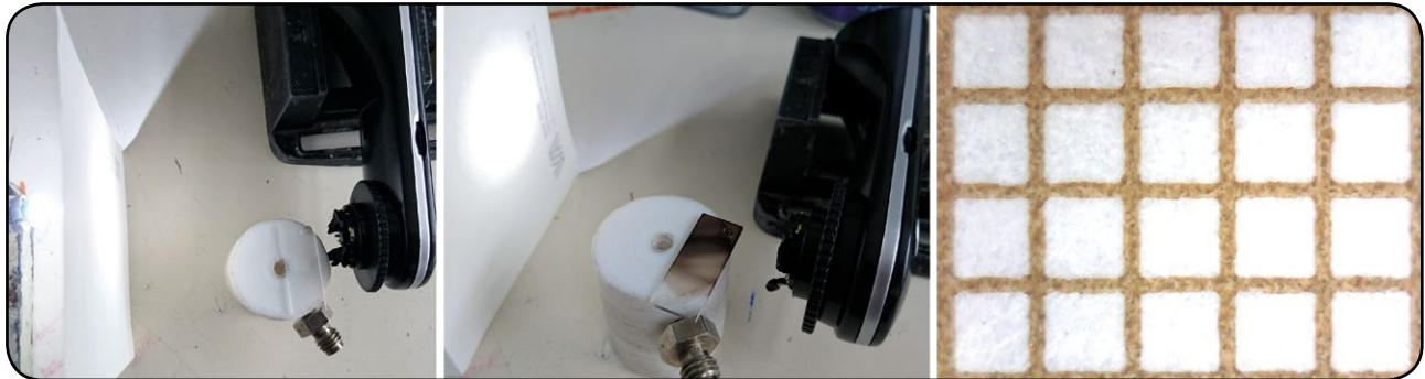
Fig. 4 : Montage expérimental de prises de vues – une webcam munie d'un objectif dont la distance focale est compatible avec des applications de macrophotographie – avec une illumination en contre-jour pour saturer en blanc le fond de l'image et faire apparaître la goutte en sombre sur fond clair. Nous constatons en prenant une photographie de papier millimétrique gradué (à droite) l'absence de déformation significative par l'optique de prise de vue.
