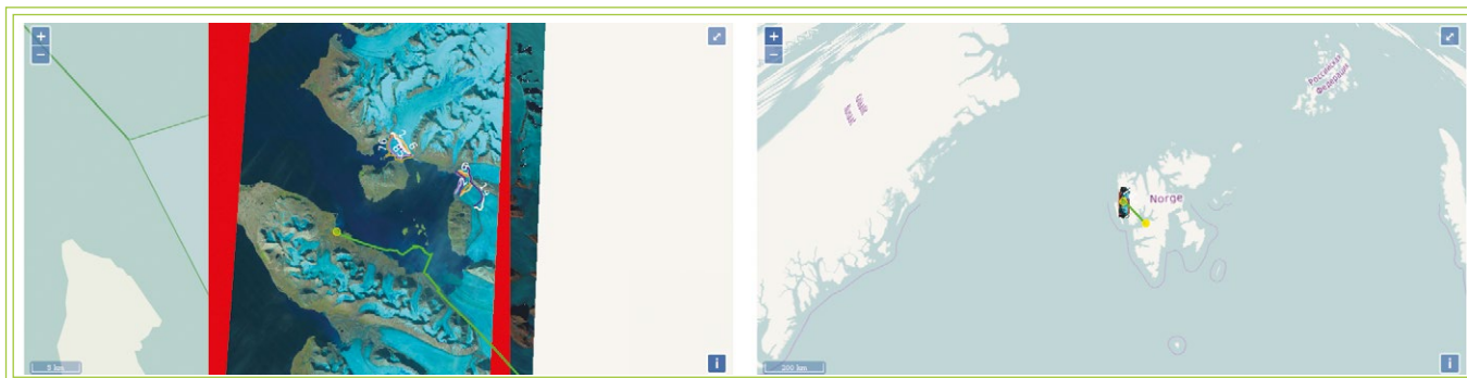
Fig. 5 : Gauche : le passage à une projection locale WGS84/UTM33N résout la déformation observée auparavant dans OpenLayers 2 et son Google Mercator. Cependant, cette projection n'a pas prétention de s'étendre à tout le globe, et réduire le grossissement met en évidence la déformation sur les régions adjacentes, ici le nord Canada et la Sibérie (droite). Cet exemple est disponible sur jmfriedt.sequanux.org/reproj.html .
