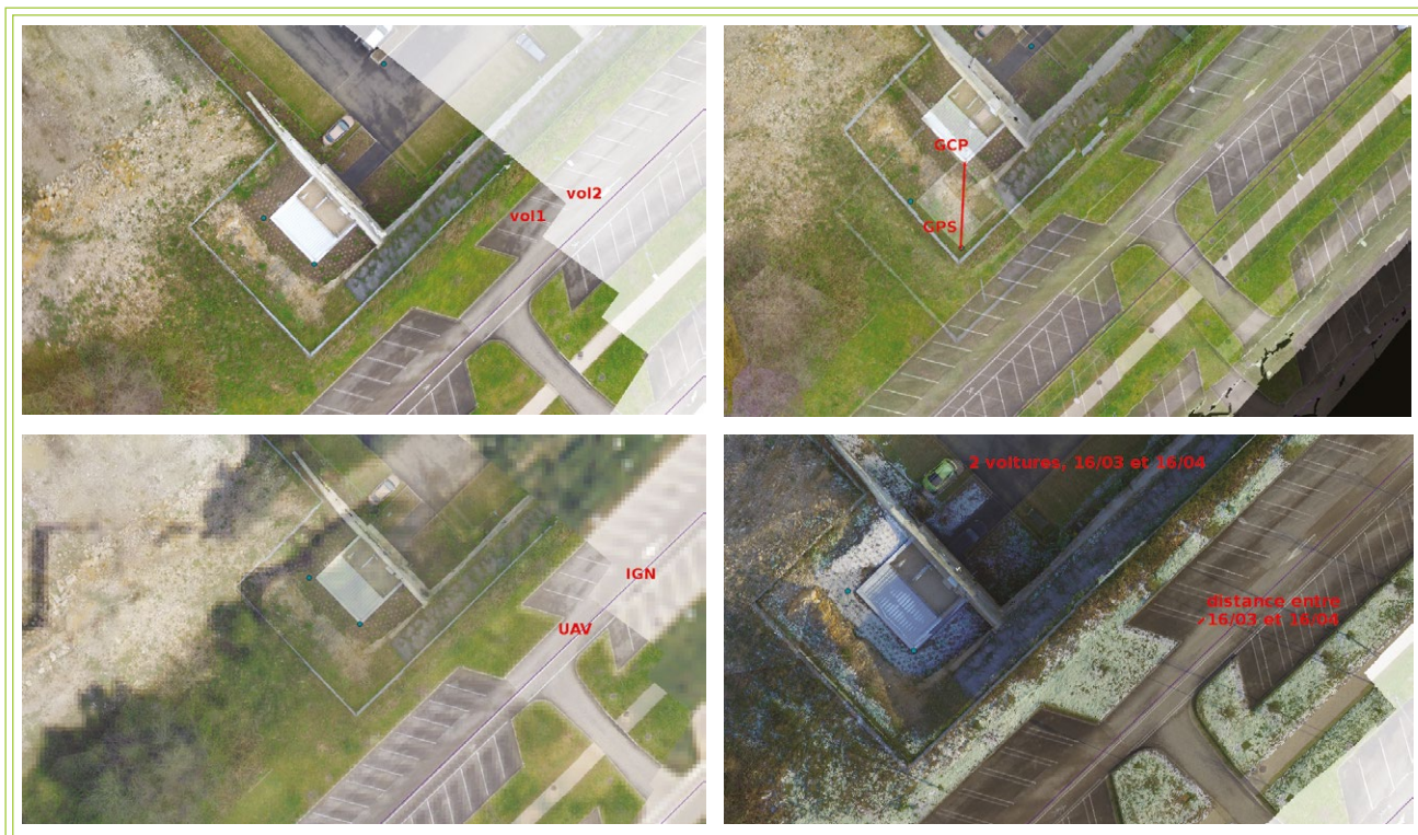
Fig. 7 : Résultat de l'insertion de trois images orthorectifiées, en comparaison de données de référence que sont les images aériennes de la BD ORTHO de l'IGN et les données vectorielles de Openstreetmaps. En haut à gauche : deux images orthorectifiées acquises à 30 minutes d'intervalle positionnées au moyen de 7 GCPs. En haut à droite : le même jeu de données, positionné uniquement par les positions GPS du drone au moment de la prise de vue. Le trait rouge, indiquant la différence de position, est long de 9,8 m. En bas à gauche : superposition d'une image produite par drone (moitié gauche) avec une image IGN (moitié droite). En bas à droite : comparaison de deux orthophotos produites à un mois d'intervalle.
