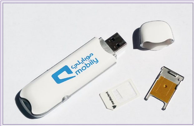
Fig. 2 : La clé USB 3G Huawei E169 (même s'il y a des choses bizarres écrites dessus, c'est bien le modèle indiqué) et un adaptateur de SIM.
