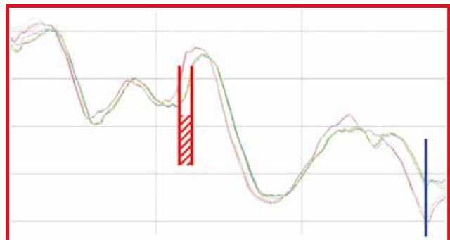
Figure 19 : Fuites différentielles de type « Timing »
