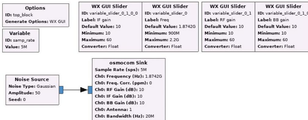
Fig. 17 : Schéma simpliste d'un Jammer pouvant servir pour brouiller des canaux mobiles 3G spécifiques un à un par exemple.
