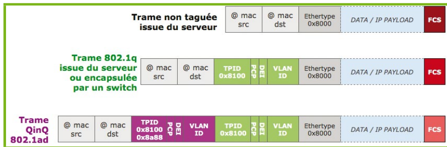
Figure 1 : Ajout des tags 802.1q et 802.1ad à une trame Ethernet.
