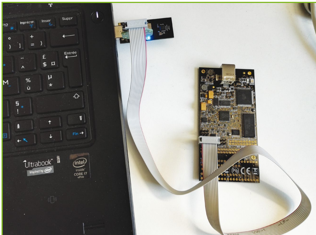
Figure 6 : Connexion du dongle RZUSBSTICK à l'ordinateur pour flashage.
